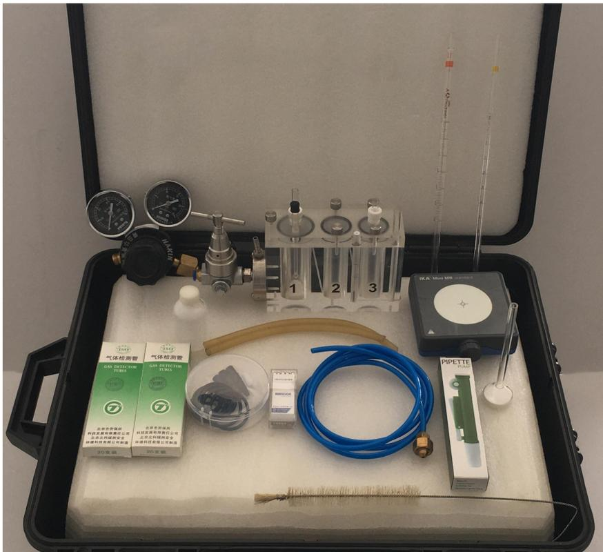
7. 旋松(逆时针)减压器 T 型螺杆，连接气源。
